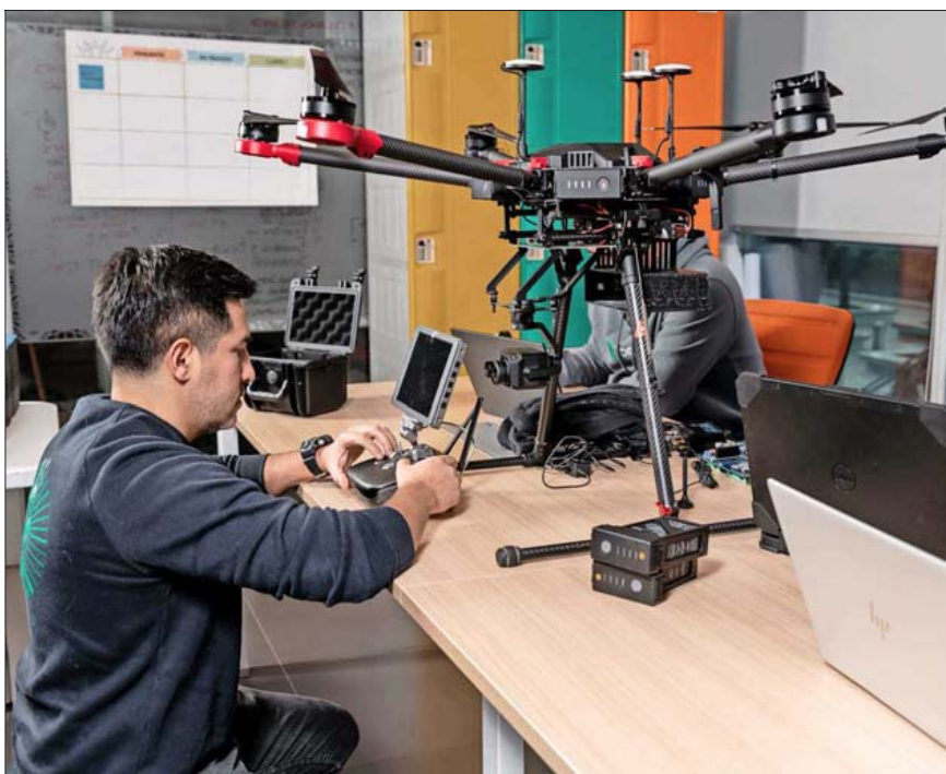
El dron sigue una ruta de monitoreo autónoma, sin manipulación por control remoto, y puede pasar más de tres horas en el aire procesando datos.
